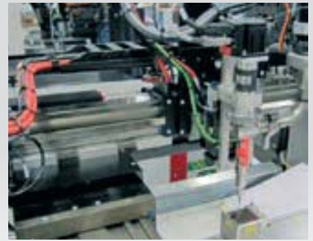
»4 Linearmotorachsen bringen mehr Geschwindigkeit in den Dosierbereich
