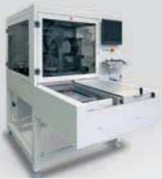
»2 Mit XYZ-Linearmotorenachsen ausgestattete Dos.Flex-Maschine. Sie bietet eine Verfahrgeschwindigkeit von 1.000 mm/s bei einer Wiederholgenauigkeit von 20 µ
