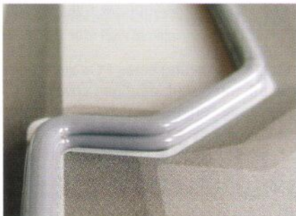
Präzise aufgebraute Silikon-Doppelraupe.
