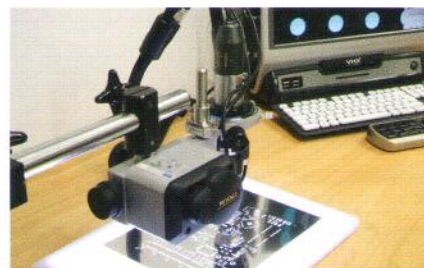
Mit dem Digitalmikroskop von Keyence lässt sich in detaillierten, omnifokalen 3-D-Aufnahmen die Genauigkeit der Laseranlage überprüfen.
